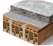
Forjados de hormigón Conector químico y Conectores hormigón.
