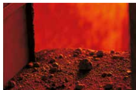
Cocción y expansión a 1200 °C.
