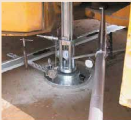
Aparato para ensayos con placa.
