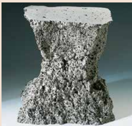
Prueba cúbica para determinar la resistencia a la compresión.
