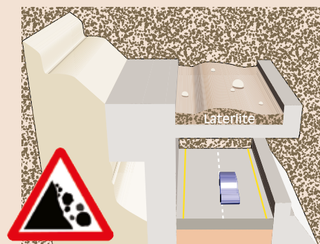
Cobertura en hormigón armado /zanja rellena con arcilla expandida para proteger la carretera.
