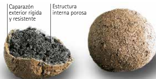
Cocción y expansión a 1200 °C.
